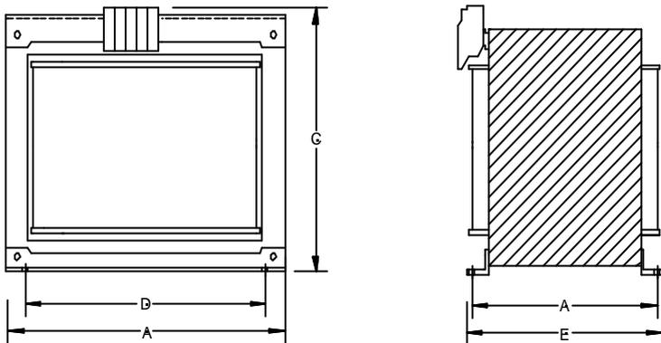
Stufentransformator mit 7 Stufen, nach VDE 0570/EN61558-2-13
